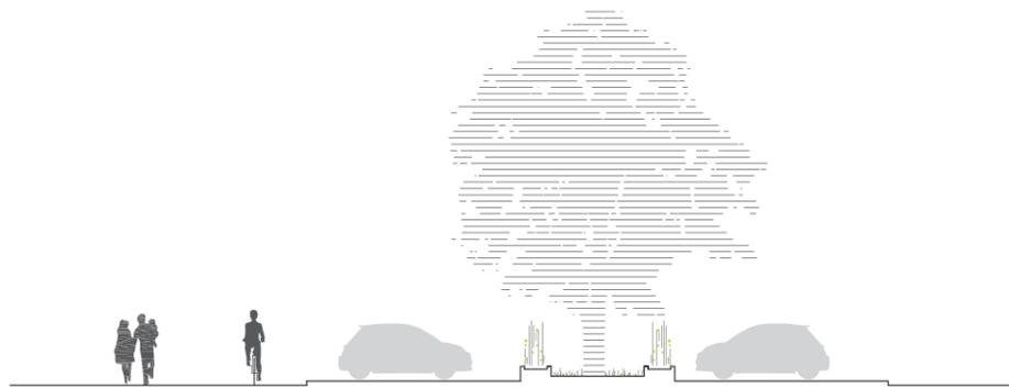
5a sezione tipo del nuovo viale ciclopedonale da pavimentare in materiale lapideo, di larghezza minima pari a m. 6,00 e accesso carrabile consentito solo per accedere ai parcheggi; valorizzazione del sistema verde alberato
