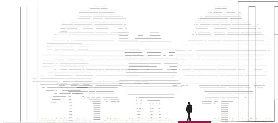
13 sezione tipo del nuovo percorso ciclopedonale che attraversa l'intera area da nord a sud nel rispetto delle alberature esistenti e della ricerca di un rapporto visivo con le torri preservate; pavimentazione in lastre di cemento di larghezza m. 3,00; ristrutturazione architettonica e funzionale dell'ex sede del tiro a segno come luogo attrezzato di interfaccia tra parco e città
