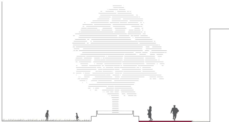
7 sezione tipo del tratto stradale di via tommaseo con pavimentazione in cubetti di porfido e restrizione dell'accessibilità carrabile; ridefinizione dell'area prospiciente palazzo visconti con interventi di riqualificazione dell'area verde e l'introduzione di un sistema di attrezzature d'arredo intorno alla significativa alberatura esistente e alla griglia di aereazione
